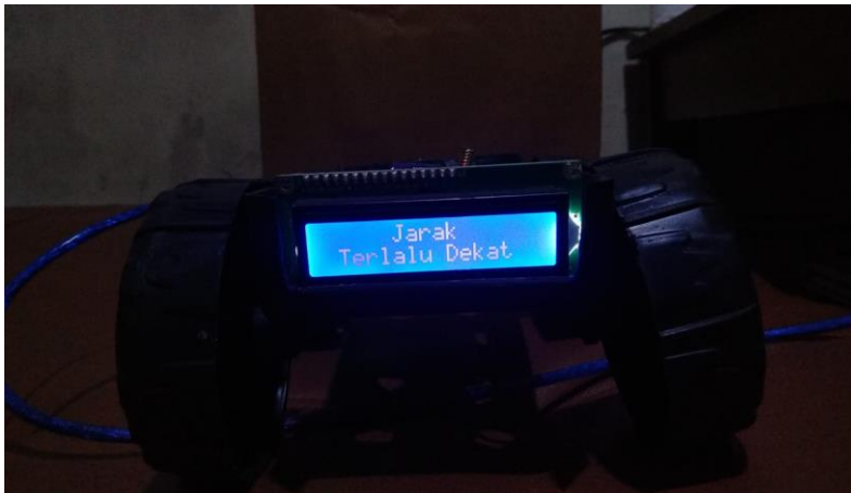
Gambar 11 Kondisi LCD ketika jarak <20cm
