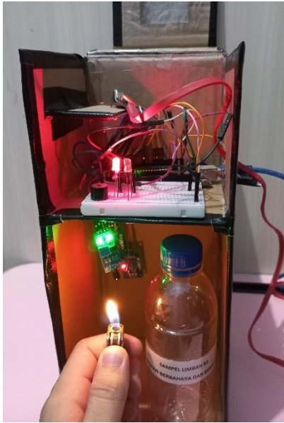
Gambar 7 : prototype mendeteksi adanya api dan gas
